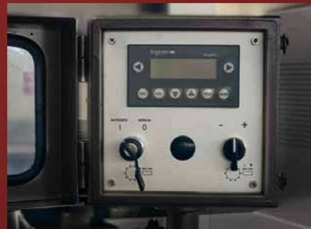
Sistema di controllo automatico dello spessore Automatic device for thickness control
