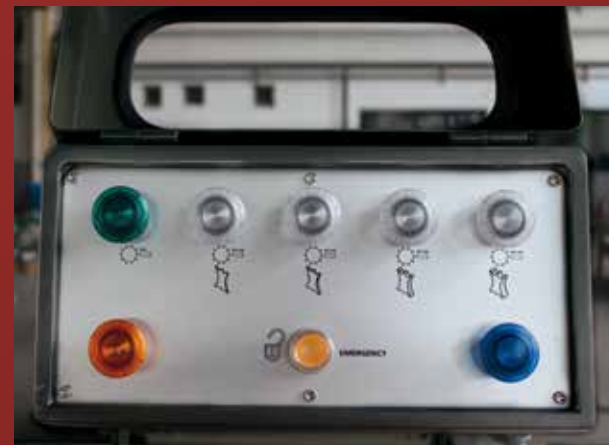
Sistema di controllo dello spessore manuale Manual device for thickness control
